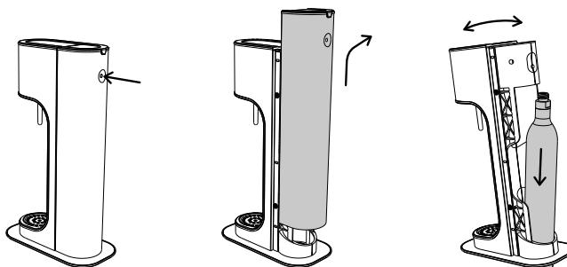
Hold danskvandsmaskinen i en vinkel fremover og før kulsyrepatornen ned gennem åbningen i bunden af maskinen, så kulsyrepatornen står på underlaget. Vip derefter danskvandsmaskinen tilbage, så overdelen af maskinen læner ind mod kulsyrepatornen gevind.
