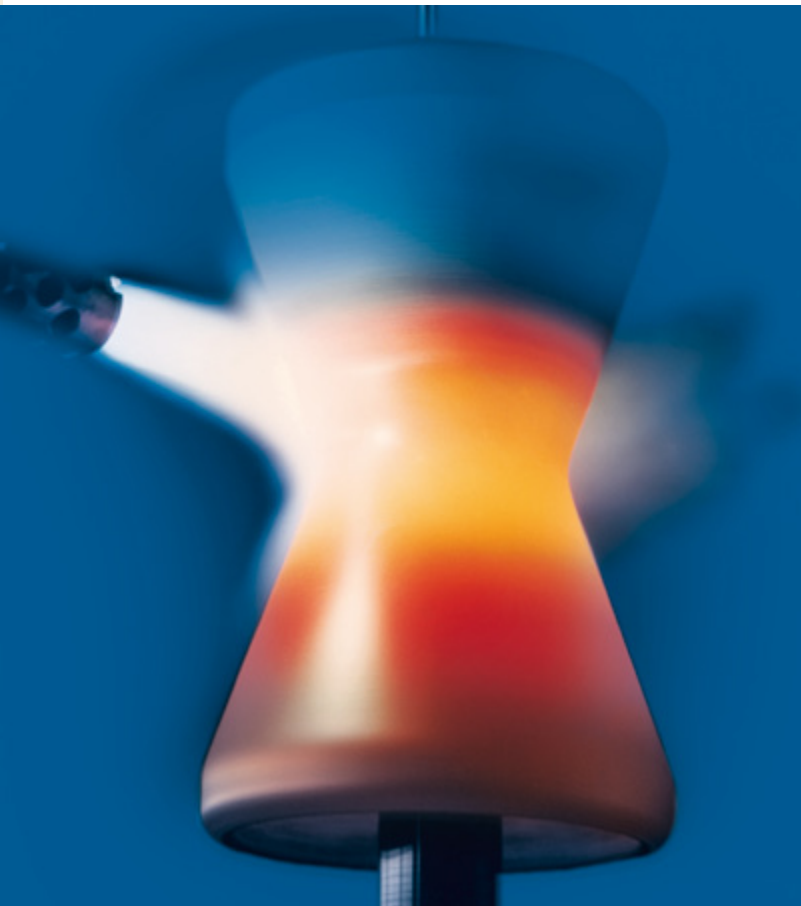
Automatisk belægning med CrNiBSi, som sprayes på et linhjul ved hjælp af flammespraying.
