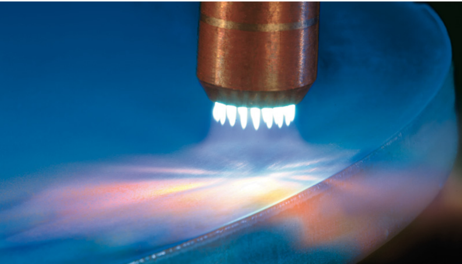
Lokal opvarmning med hjælp af en acetylen-oxygenbrænder.
